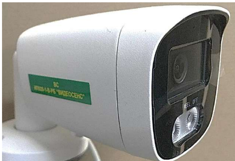
Рисунок 1.3 – Вариант выносного видеосенсора (IP-видеокамера) ИПВ.
