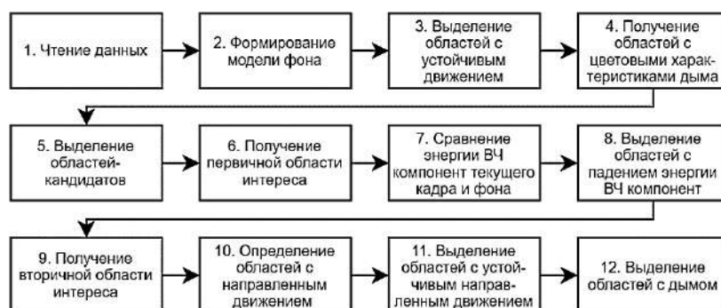
Рисунок П.1 – Принцип обнаружения дыма.
