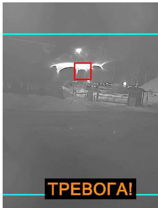
Рисунок 23 – Ложное срабатывание, вызванное каплями на объективе ВС.
