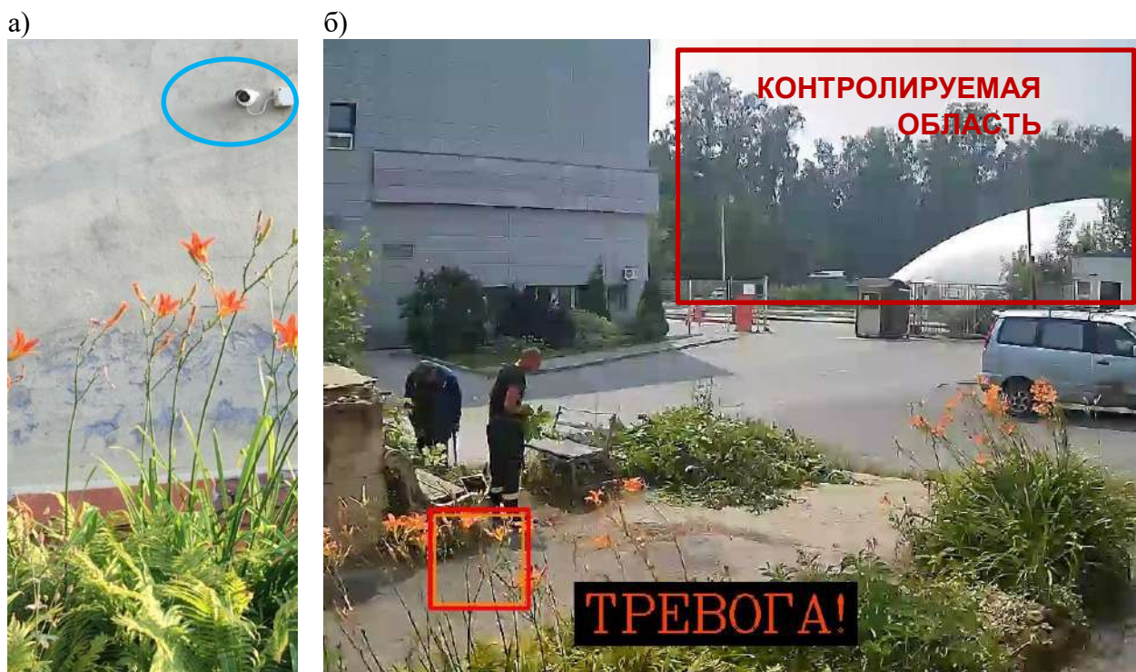
Рисунок 15 – Срабатывание ИПВ на движение объектов переднего плана.
