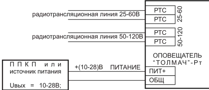
Рис. 1. Типовая схема подключения оповещателя «Толмач»П-Рт с запуском по появлению напряжения радиотрансляционной сети.
