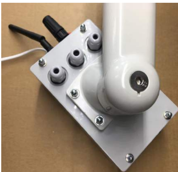
Рисунок 4 – нижняя часть блока ТИКС «Снегирь» и крепление кронштейна.
