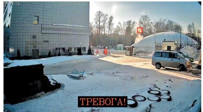
Рисунки 9-10. Обнаружение области дыма и включение в видеопоток области дыма, точных областей дыма (при включении опции в установках), надписи «Тревога» (при включённой опции в установках)
