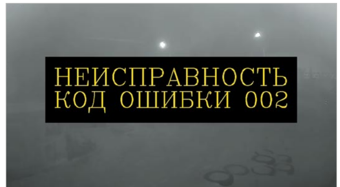
Рисунок 12. Неисправность извещателя по перекрытию поля зрения видеокамеры.
