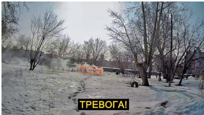
Рисунки 9-10. Обнаружение области дыма и включение в видеопоток области дыма, точных областей дыма (при включении опции в установках), надписи «Тревога» (при включённой опции в установках)
