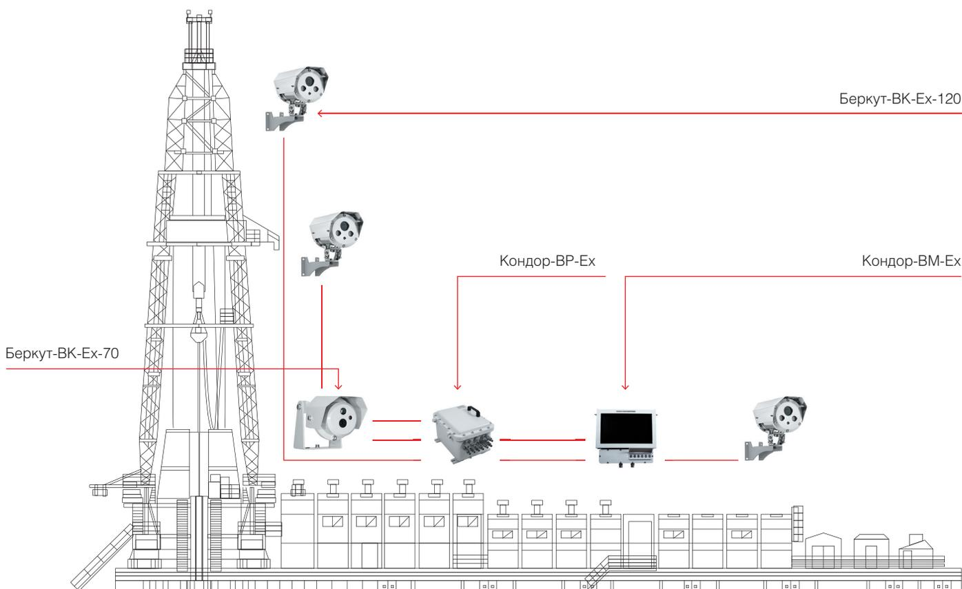
Взрывозащищенные уличные стационарные видеокамеры и видеокамеры рабочего места оператора Беркут-ВК-Ex-70/120, монитор Кондор-ВМ-Ex и видеорегистратор Кондор-ВР-Ex, размещаются во взрывоопасной зоне. Контроль процессов осуществляется оператором на мониторе, получающем сигнал от видеорегистратора.
