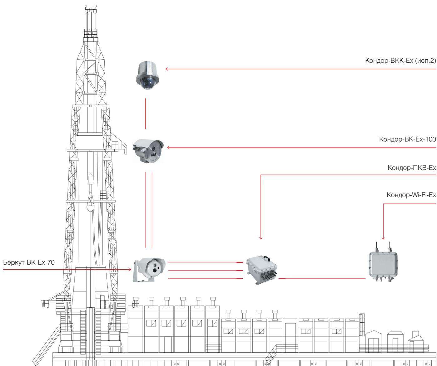
Взрывозащищенные уличные стационарные видеокамеры Беркут-ВК-Ех-70/120, видеокамеры PTZ Кондор-ВКК-Ех (исп.2), коммутатор Кондор-ПКВ-Ех и Wi-Fi маршрутизатор Кондор-Wi-Fi-Ех, размещаются во взрывоопасной зоне. Передача видеосигнала на удаленное рабочее место оператора осуществляется от коммутатора Кондор-ПКВ-Ех по кабелю или по радиоканалу от маршрутизатора Кондор-Wi-Fi-Ех.
