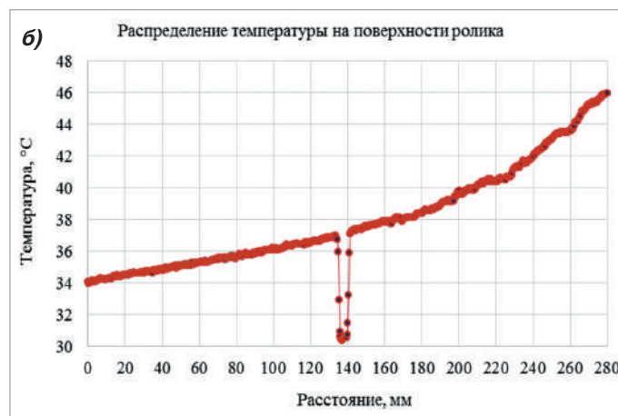
Рисунок 8. Перегрев 50°C правым подшипником:
