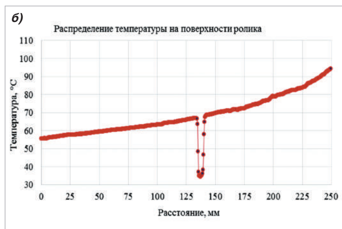
Рисунок 9. Перегрев 200°C правым подшипником:
