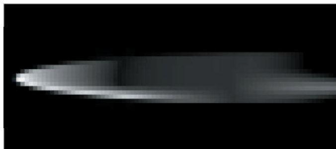
Рисунок 11. Пример теплового следа на прямом ходу ленты от подтормаживающего центрального верхнего ролика. Термограмма получена с помощью тепловизионного регистратора ТИКС «Снегирь».
