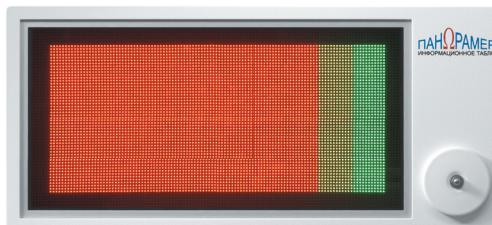
**Рисунок 13. Вариант вывода состояния технологического процесса «НЕ норма»**
